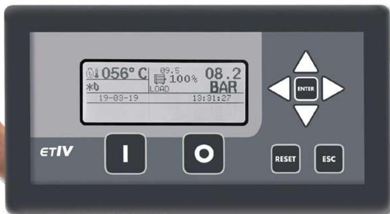
Steuereinheit mit multifunktionalem, hintergrundbeleuchtetem Display; alphanumerisches Menü. Im Hauptbildschirm wird Folgendes angezeigt:
