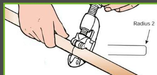
Das Rohr muss sauber mit einem Rohrschneider abgetrennt werden! Keine Säge verwenden!
