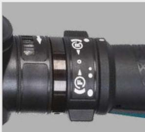
Drehmoment im Rechts- und Linkslauf verstellbar
