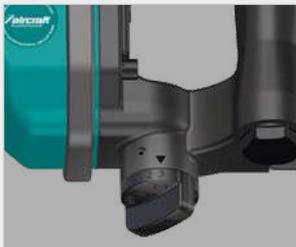
Drehmoment im Rechts- und Linkslauf dreistufig verstellbar
