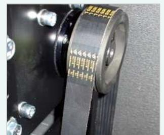
• Hochwertiger Rippenbandriemen gewährleistet optimale Kraftübertragung von Motor zu Verdichter bei gleichzeitig hoher Standzeit
