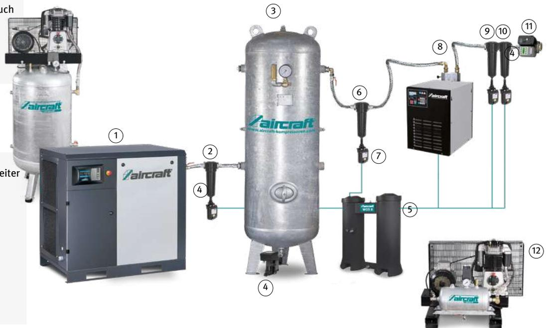
Ebenfalls direkt dem Schraubenverdichter (1) nachgeschaltet ist ein Zyklon-Wasserabscheider (2) zur 99%igen Vorabscheidung von Wasser.
